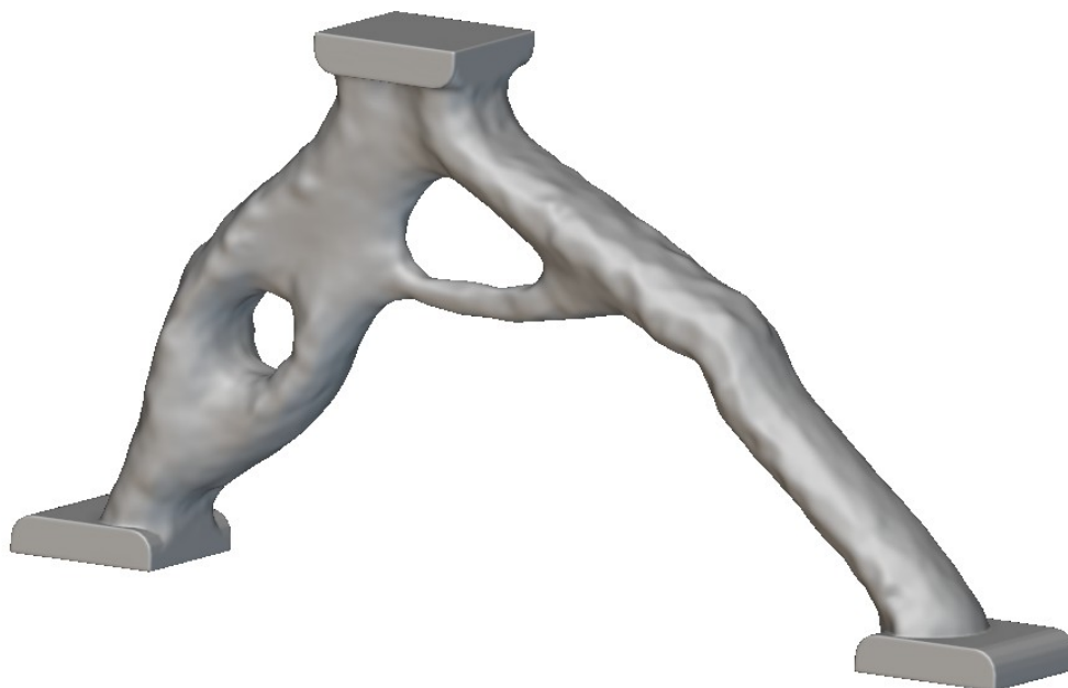
Rys. 7.7: Wspornik po wygładzeniu i dodaniu elementów mocowania, siatka 3 mm.
