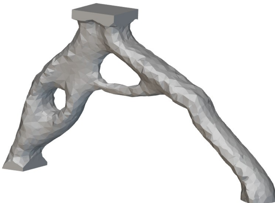
Rys. 7.6: Wynik optymalizacji przed obróbką, siatka 3 mm.
