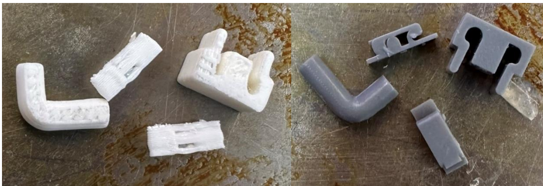
Rysunek 9.3. Wytworzone elementy implantu żebrowego (po lewej z ABS, po prawej z żywicy Phrozen TR300).
