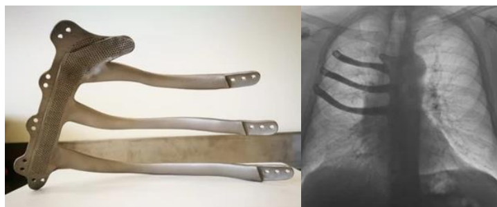
Rysunek 4.5. Implant żebrowy (po lewej gotowy model, po prawej zdjęcie radiograficzne klatki piersiowej z wszczepionym implantem) [18].
