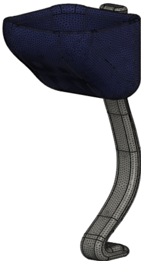
Rys. 6.12 Wygenerowana siatka dla modelu – symulacja częstotliwościowa
