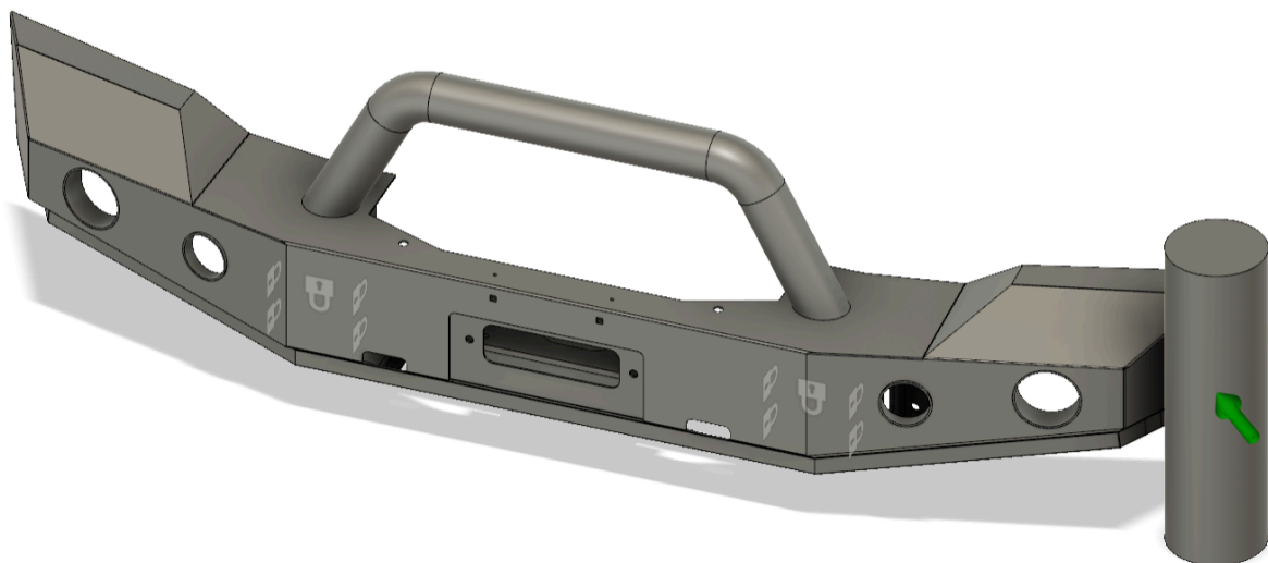
Rysunek 5.3.5 Utwierdzenie modelu w warunkach rzeczywistych - uderzenie boczne.
