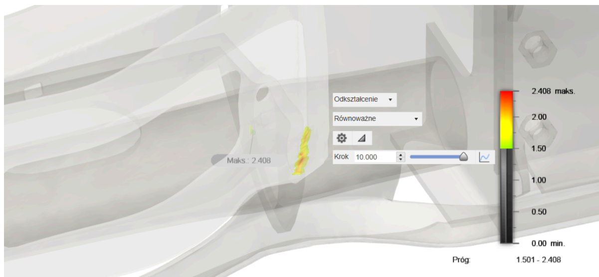
Rysunek 5.4.17 Wartości odkształceń modelu zderzaka - uderzenie czołowe.
