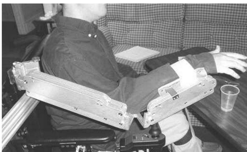
Rys. 4.5. Zrównoważona orteza przedramienia [10].
