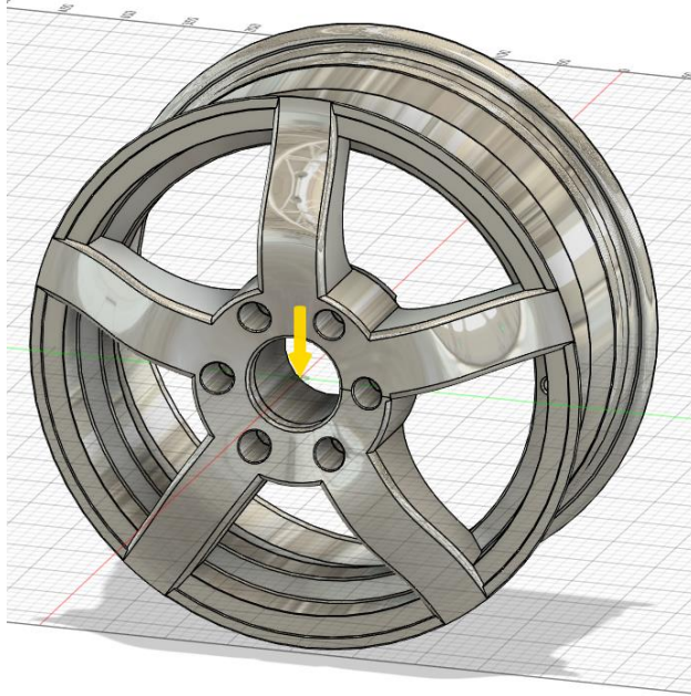
Rysunek 7.6 Felga obciążona siłą grawitacji
