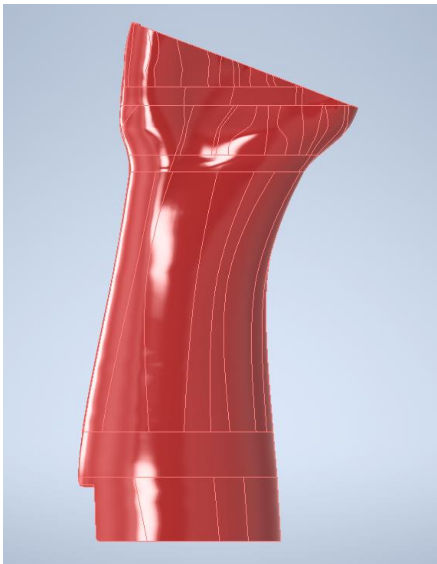
Rys. 8.2. Model 3D ortezy - widok z tyłu.
