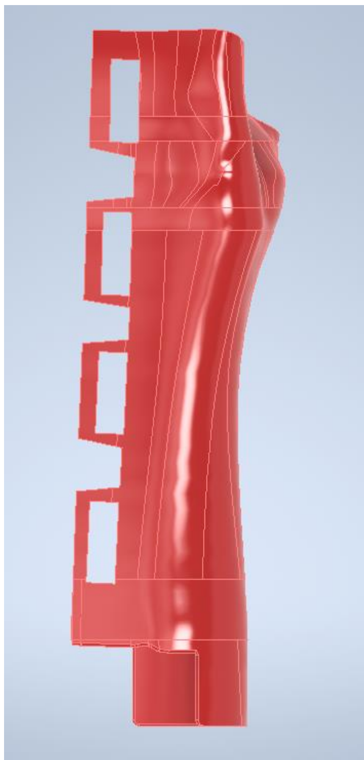
Rys. 8.3. Model 3D ortezy - widok z boku.
