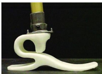
Rysunek 10 Stopa Niagara podczas testów [27].
