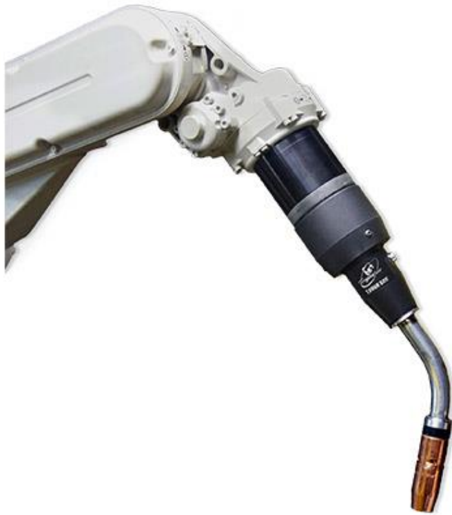
Rys. 4. Przykład palnika spawalniczego z rozwiązaniem „thru-arm” firmy Thoughtgun ( www.tregaskiss.com ).
