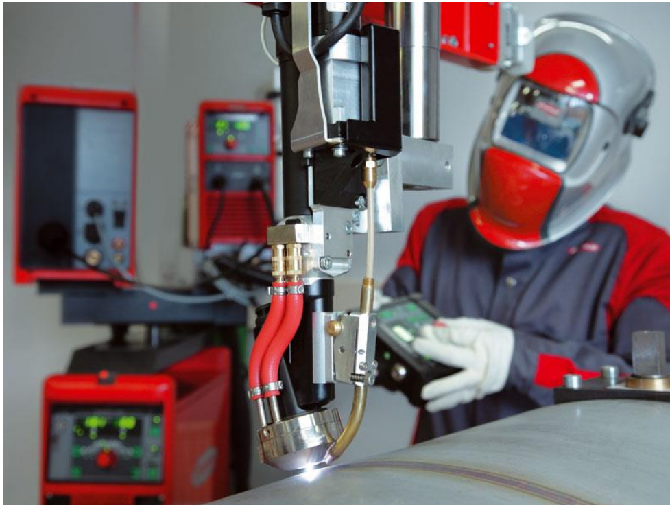
Rys. 2. Przykładowy palnik plazmowy, na zdjęciu widać poziom skomplikowania konstrukcji. Zdjęcie pochodzi od firmy Fronius- Polska ( www.fronius.com ).
