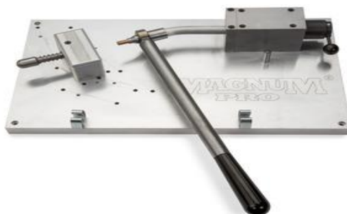
Rys. 9. Imadło do wyginania lub wyprostowywania rury palnika spawalniczego na przykładzie produktu firmy Magnum Pro ( www.lincolnelectric.com ).
