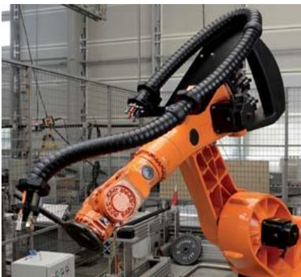
Rys.14. Przykład przewodu prowadzącego spawalniczych robotów przemysłowych ( www.igus.com ).
