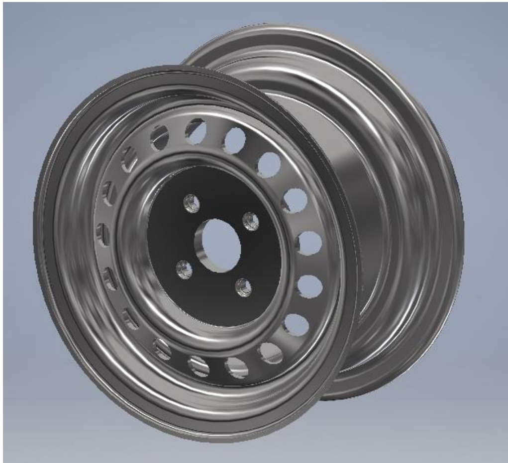
Rys. 21. Zamodelowana felga R13
