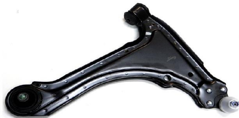
Rys. 19. Porównanie zamodelowanego wahacza z wahaczem z samochodu Opel Astra F
