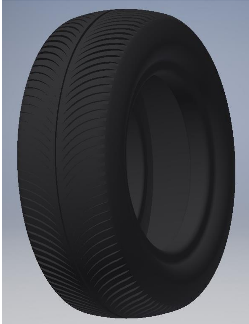
Rys. 24 Zamodelowana opona na podstawie opony GoodYear Vector 4Season gen. II 175/70 R13
