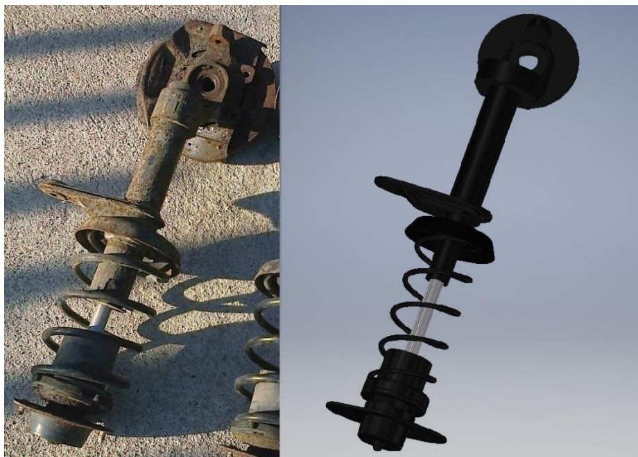
Rys. 16. Porównanie zamodelowanej kolumny MacPhersona z kolumną samochodu Opel Astra F
