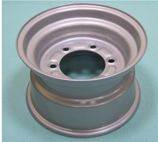
Rys. 2.2 Wygląd felgi nr 2 (z przetłoczeniami). Strona wewnętrzna.
