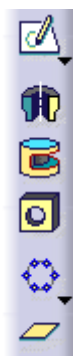
Rys. 2.5 Narzędzia programowe wykorzystane w celu wykonania modelu felgi oraz piasty. Od góry kolejno: Szkicownik ( Sketch ), Obrót ( Shaft ), Wycinanie rowków ( Groove ), Szyk kołowy ( Circular Pattern ) i Płaszczyzna ( Plane ).
