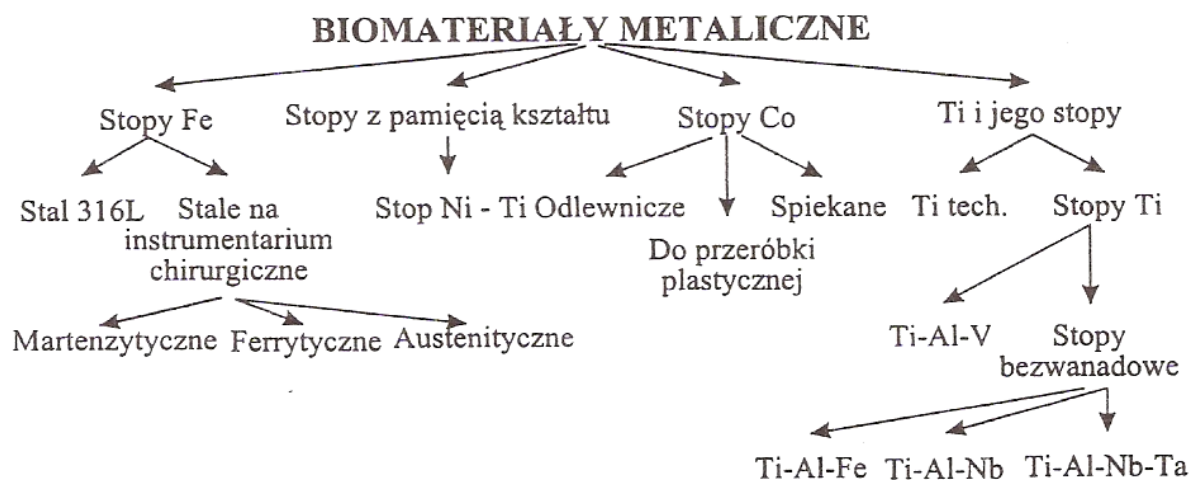
Rys. 3 Przykłady stosowanych biomateriałów metalicznych. [1]
