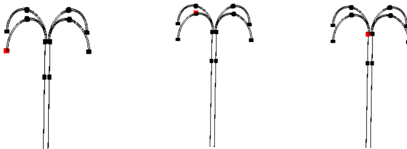
Rys. 20 Rozmieszczenie punktów pomiaru wzrostu temperatury w czasie a) na początku elektrody, b) na środku elektrody, c) na końcu elektrody.
