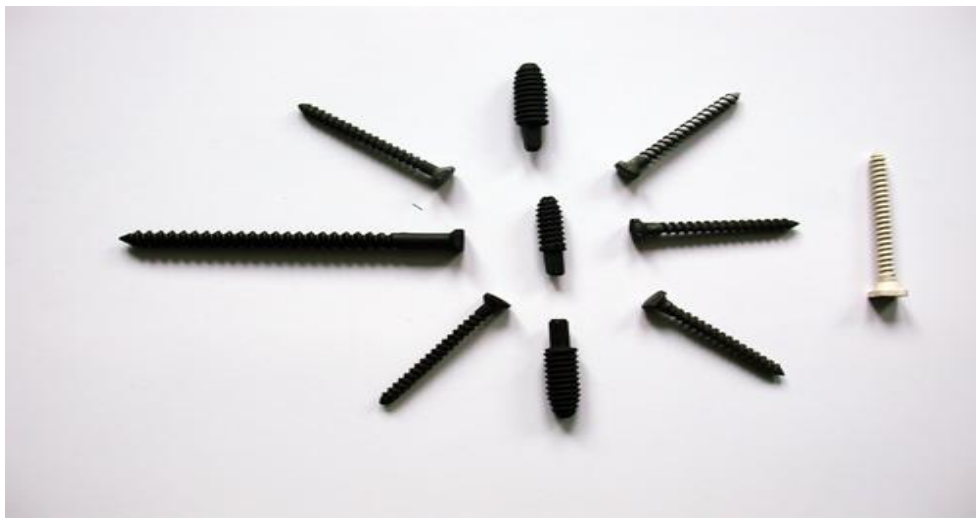
Rys. 9 Śruby dla ortopedii z polimerów biostabilnych, resorbowalnych i z materiałów kompozytowych.
