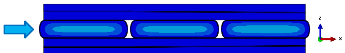
Rys. 6.7.27 Rozkład temperatury w przekroju XZ w odległości 760 mm od strony wlotowej rurek
