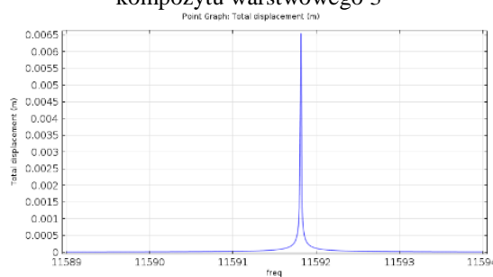
Rys. 9.2.22 a) Amplituda drgań wymuszonych dla kompozytu warstwowego 3
